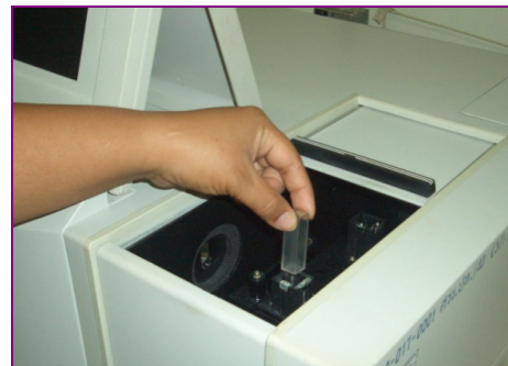
ภาพผนวกที่ 6 การเตรียมตัวอย่าง (ก) และการวัดปริมาณมิโลสด้วยเครื่องสเปกโตรโฟโตมิเตอร์ (ข) โดยวิธีของ Juliano (1971, 1972)
